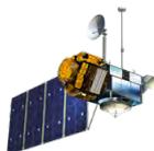
Lancé en 1992, l'altimètre Poséidon, combiné avec l'instrument Doris, mesure avec une précision de quelques centimètres la surface de l'océan.
