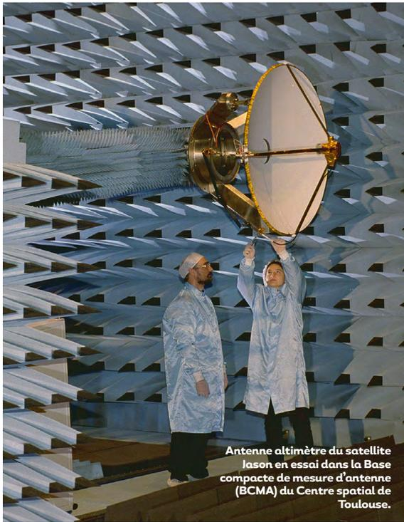
Antenne altimètre du satellite Jason en essai dans la Base compacte de mesure d'antenne (BCMA) du Centre spatial de Toulouse.
